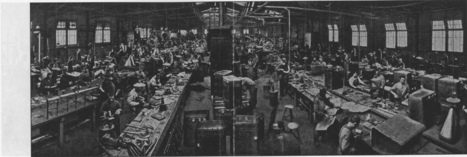
Flugzeugproduktion bei der LVG: Blick in die 1915 errichtete Großschlosserei zur Anfertigung und verspannen der Gümpfe und Motorhauben. (Aus: LVG 1919. Foto: Waldemar Tietzenthaler)
